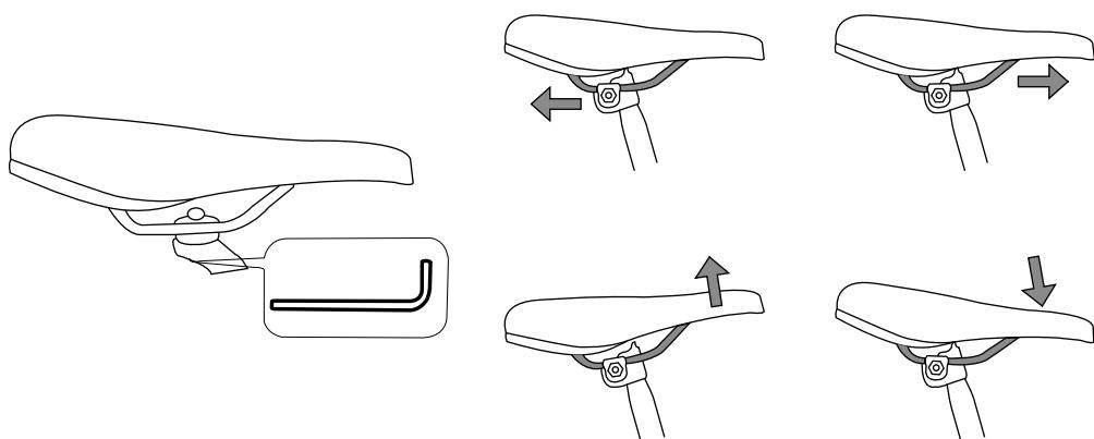
一体式座管的坐垫调整（内六角扳手）将坐垫锁紧螺丝松开，可以对坐垫
